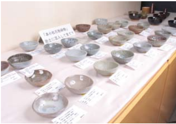
「本小松石のやきものへの利用」研究成果紹介コーナー。胎土および釉薬に本小松石粉をさまざまに配合して焼成したテスト焼成作品
