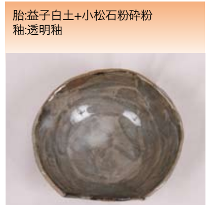
胎土 益子白土+小松石粉碎粉30% 釉薬 内側:小松石粉碎粉のみ 上から全体に 市販の3号透明釉 窯種類 灯油窯 焼成 本焼き1230°C 弱還元
