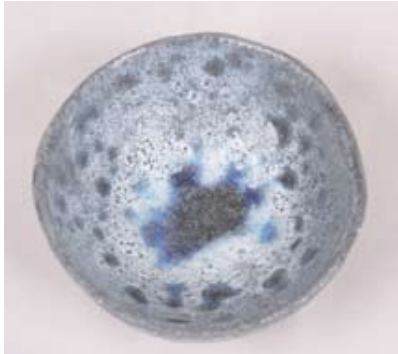
胎土 古信楽細土+小松石粉碎粉30% 釉薬 市販の3号透明釉、厚掛け 窯種類 電気窯 焼成 本焼き1230℃ 楽釉にて焼き戻し1025℃酸化焼成
