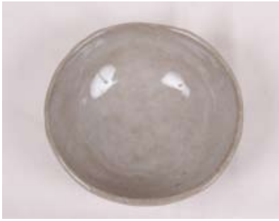
胎土 益子白土+小松石粉碎粉30% 釉薬 市販の3号透明釉、厚掛け 窯種類 灯油窯 焼成 本焼き1230°C 弱還元
