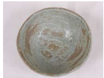
胎土 古信楽細土+小松石粉碎粉20% 釉薬 並白+小松石粉碎粉50% 窯種類 電気窯 焼成 本焼き1230℃ 3号透明釉にて1230℃で2度焼き 酸化焼成
