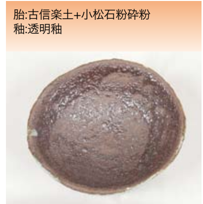
胎土 古信楽細土+小松石粉碎粉20% 釉薬 内側:小松石粉碎粉のみ 外側:3号透明釉 窯種類 電気窯 焼成 本焼き1230℃ 酸化焼成
