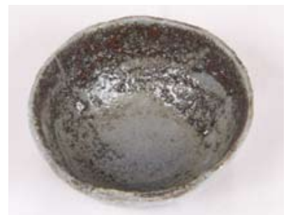
胎土 古信楽細土+小松石粉碎粉20% 釉薬 内側:小松石粉碎粉のみ 外側:3号透明釉 窯種類 電気窯 焼成 本焼き1230℃ 楽釉にて焼き戻し1025℃ 酸化焼成
