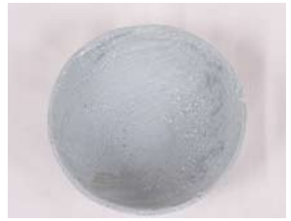
胎土 古信楽細土+小松石粉碎粉20% 釉薬 市販の3号透明釉、薄掛け 窯種類 電気窯 焼成 本焼き1230°C 酸化焼成
