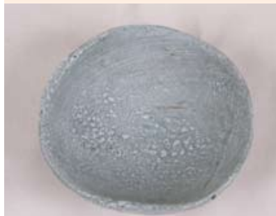
胎土 古信楽細土+小松石粉碎粉30% 釉薬 市販の3号透明釉、薄掛け 窯種類 電気窯 焼成 本焼き1230℃ 酸化焼成
