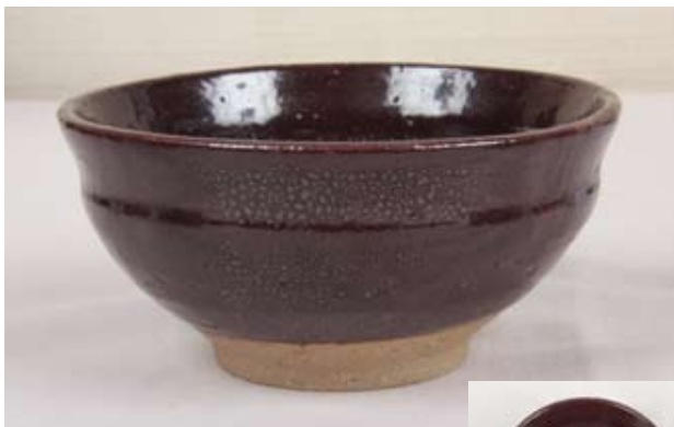
作品：茶碗 釉薬：インド長石40%+(本小松石9+弁柄1)60%による油滴天目 焼成：電気窯、1230°C、酸化焼成。弁柄を入れたことで赤くなっている。コバルトの少量添加で銀色の油滴となると予想される
