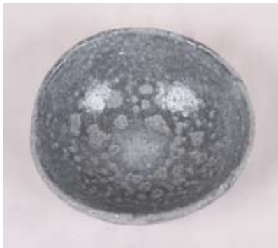
胎土 古信楽細土+小松石粉碎粉30% 釉薬 市販の3号透明釉、厚掛け 窯種類 電気窯 焼成 本焼き1230℃ 酸化焼成
