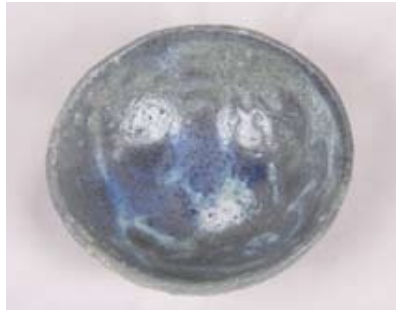
胎土 古信楽細土+小松石粉碎粉30% 釉薬 並白+小松石粉碎粉20% 窯種類 電気窯 焼成 本焼き1230℃ 楽釉にて焼き戻し1025℃ 酸化焼成
