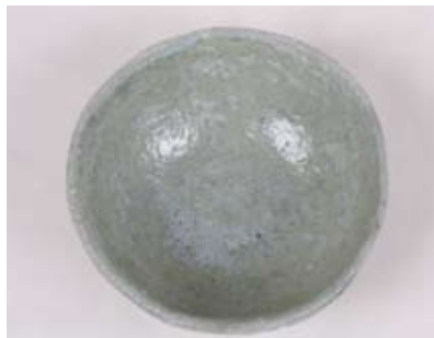
胎土 信楽細土+小松石粉碎粉20% 釉薬 並白+小松石粉碎粉20% 窯種類 電気窯 焼成 本焼き1230℃ 酸化焼成
