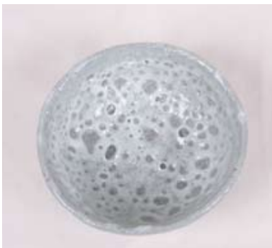
胎土 益子白土+小松石粉碎粉40% 釉薬 市販の3号透明釉、厚掛け 窯種類 電気窯 焼成 本焼き1230°C 酸化焼成
