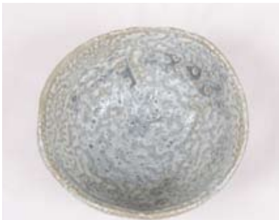
胎土 益子白土+小松石粉碎粉20% 釉薬 市販の3号透明釉、厚掛け 窯種類 電気窯 焼成 本焼き1230°C 酸化焼成
