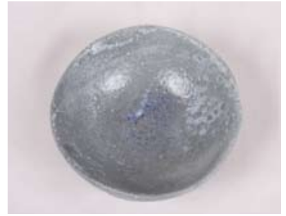
胎土 古信楽細土+小松石粉碎粉20% 釉薬 市販の3号透明釉、薄掛け 窯種類 電気窯 焼成 本焼き1230°C 楽釉にて焼き戻し1025°C 酸化焼成
