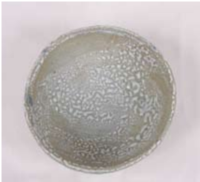
胎土 益子白土+小松石粉碎粉20% 釉薬 市販の3号透明釉、薄掛け 窯種類 電気窯 焼成 本焼き1230°C 酸化焼成
