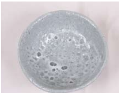
胎土 古信楽細土+小松石粉碎粉40% 釉薬 市販の3号透明釉、厚掛け 窯種類 電気窯 焼成 本焼き1230℃ 酸化焼成
