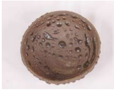
胎土 益子白土+小松石粉碎粉30% 釉薬 並白+小松石粉碎粉50% 窯種類 電気窯 焼成 本焼き1230°C 酸化焼成
