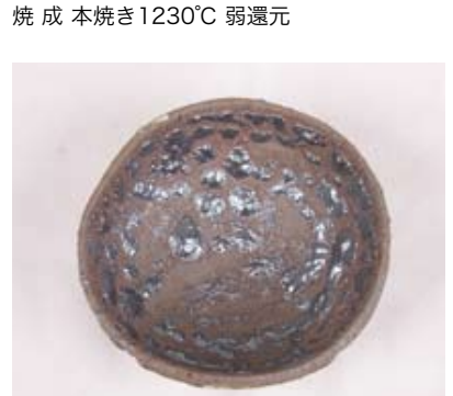
胎土 益子白土+小松石粉碎粉30% 釉薬 内側:小松石粉碎粉のみ 外側:3号透明釉 窯種類 電気窯 焼成 本焼き1230°C 酸化焼成
