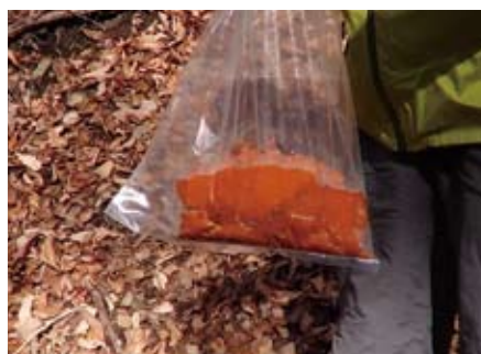
泥土は精製する必要があるが、ベンガラ(鉄釉)の原材料などになる。
