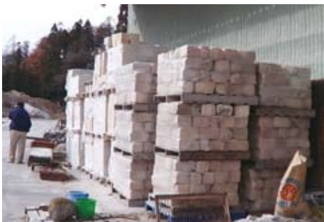
国産およびロシアからの輸入黒曜石などを用いてパーライトを生産していた工場に積み上げられていた炉材の煉瓦。
