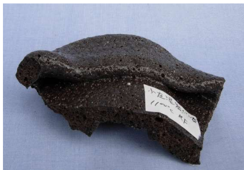
写真3 1100℃焼成で崩れた湯呑
