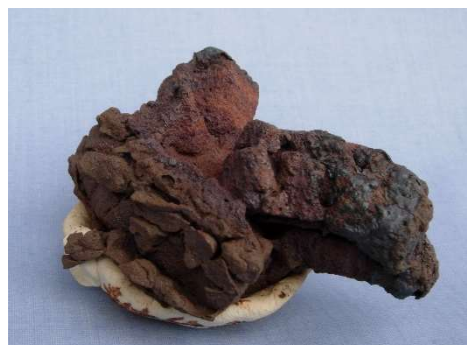
写真4 1100℃焼成で膨張した岩石片
