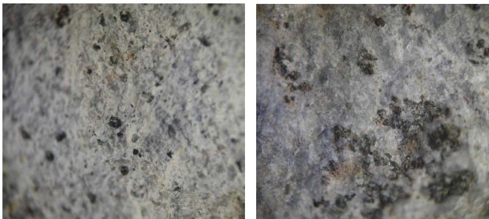
写真1 芦野石（左）と白丁場石（右）の顕微鏡写真（X20）
