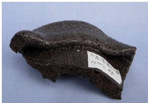
写真 3 1100℃焼成で崩れた湯呑
