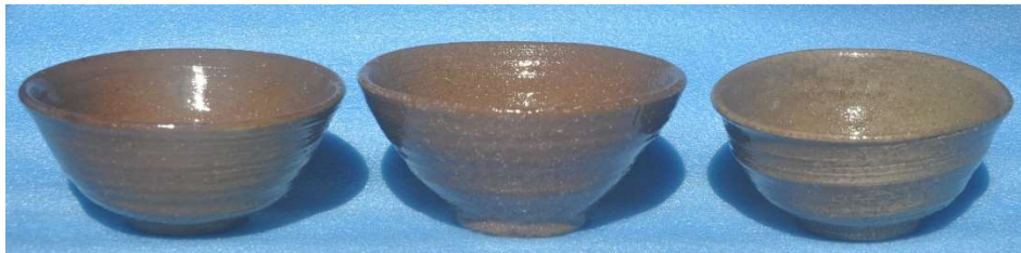
写真6 TB-1 単味と調整粘土による抹茶碗の焼成 (1100℃、酸化焼成)
