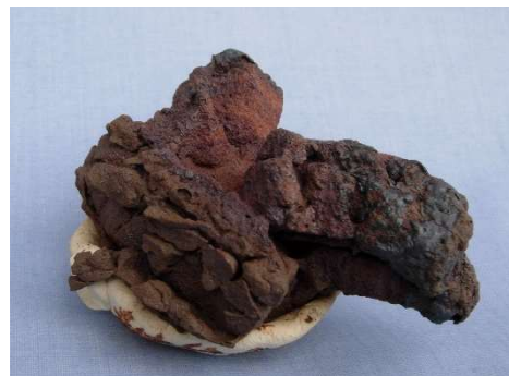
写真 4 1100℃焼成で膨張した岩石片
