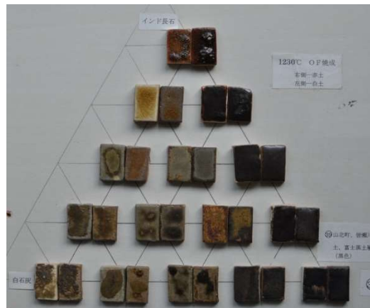
写真7 インド長石—白石灰—T B—1 の焼成テスト (1230℃)
