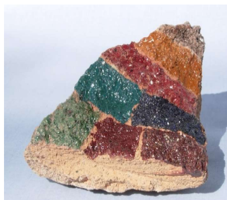
写真10 芦野石に上絵付テスト 800℃焼成
