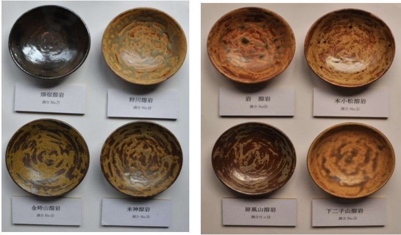
写真4 8溶岩による小皿の焼成
