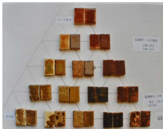
写真7 インド長石—白石灰—T B—1 の焼成テスト (1230℃)
