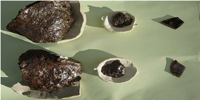
写真3 岩石片と微粉末の 1230℃焼成結果
